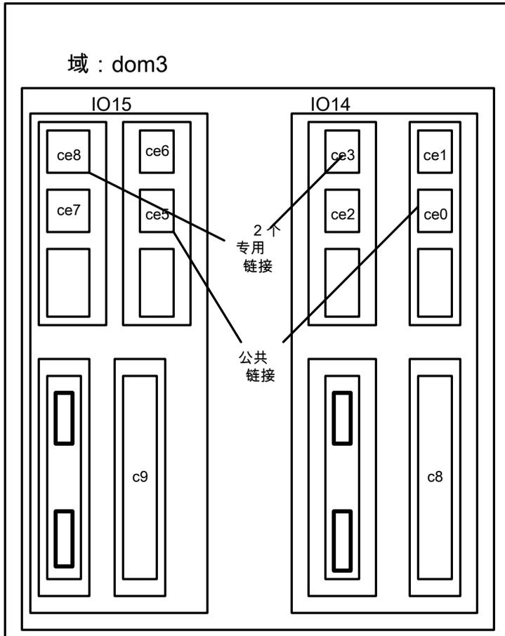
对于 e12K/15K/25K: 在以下情形中, 群集由域 dom3 和 S6800f0 组成。群集在包含 I/O 板 IO14 和 IO15 的域 dom3 上运行服务组。由于组件出现故障, IO15 要求执行动态重新配置。域 S6800f0 包含 I/O 板 IB8 和 IB6。下列图解中标记了磁盘控制器和 NIC。
