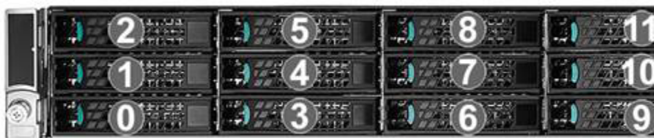
图 1 NetBackup 5330 设备计算节点的前视图
