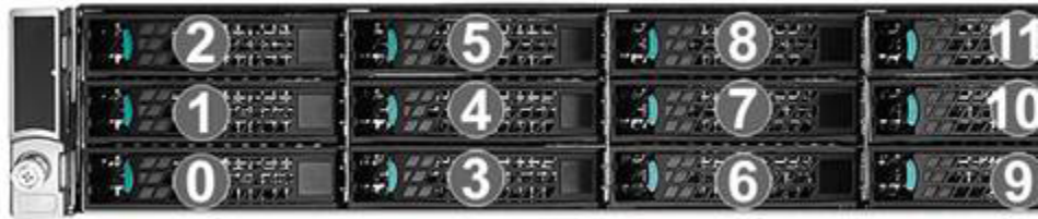
図 1 NetBackup 5330 アプライアンス計算ノードの前面図
